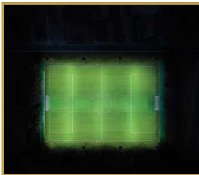
Exempel på område belyst med Darklicht-strålkastare med sin patenterade Cut-Off-teknik ger den en tydlig gräns mellan belyst och obelyst område.
